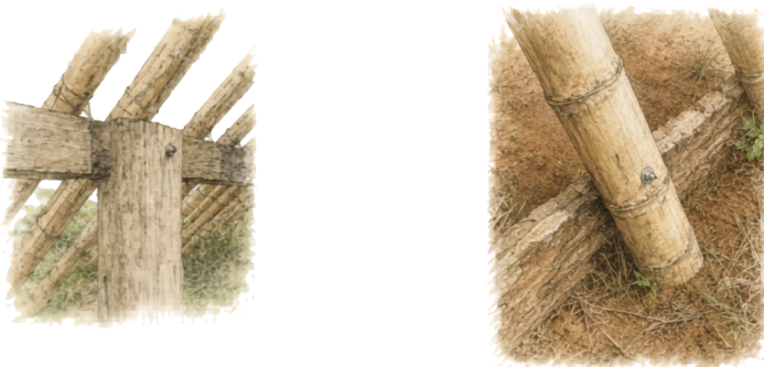
Detalhes dos encaixes com uso de barras rosqueadas e cortes de encaixe
